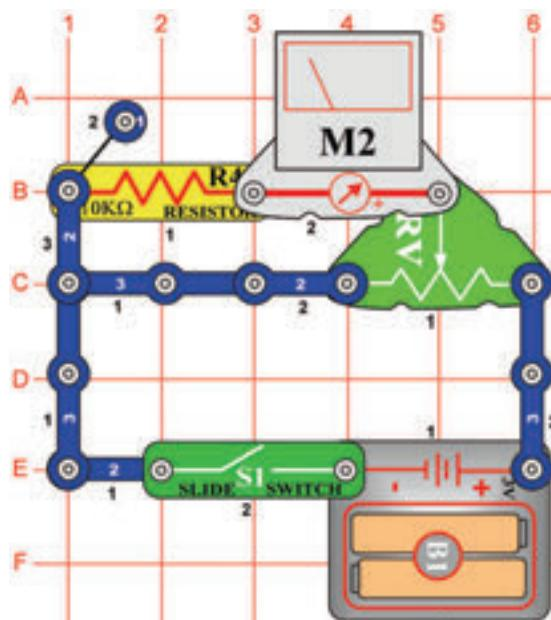
Ciel: Vytvoriť nastaviteľný rozdeľovač napäcia.
