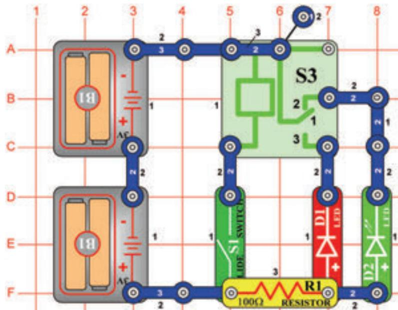
*Ciel:* Zapnúť a vypnúť LED diódu pomocou relé.
