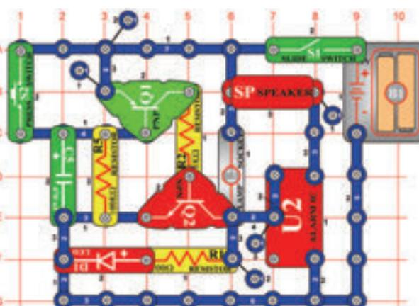
Nahradte jednokontaktný vodič na U2 dvoj-kontaktným vodičom a pripojením ich k bodom D7 a E7. Obvod bude teraz vytvárať iný zvuk. Zmeňte kombináciu pre R5 a C5 takto:
