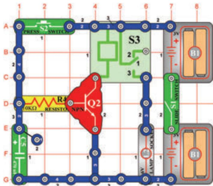
*Ciel:* Vytvoriť manuálny spínač pomocou relé.
