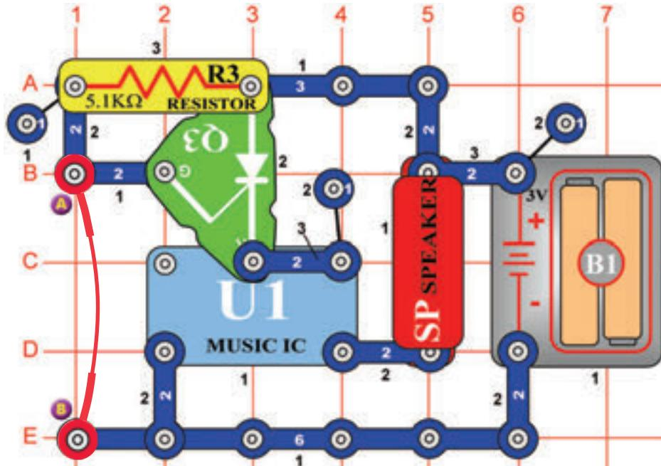
Poplašný obvod je aktivovaný, ak odstráňte spojovací drôt z bodov A a B. Spojovacie drôt skratuje prechod usmerňovače (Q3) a usmerňovač teda nevedie prúd. Ak odstráňte spojovací drôt, napäťe sa premiestní na prechod a usmerňovač prepúšta prúd. Tým sa batéria pripojí k integrovanému obvodu „Hudba“ a zaznie melódia.
